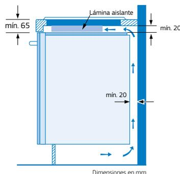
En el caso de la instalación de una placa de inducción sobre la gama de lavavajillas Compactos Integrables Balay solo hay que tener en cuenta la medida de la parte frontal de la encimera de 60 mm.
