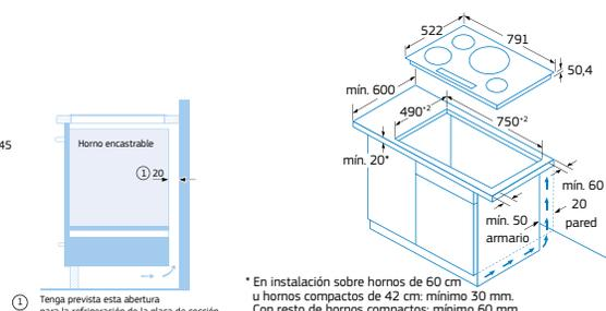
\* En instalación sobre hornos de 60 cm u hornos compactos de 42 cm: mínimo 30 mm. Con resto de hornos compactos: mínimo 60 mm.
