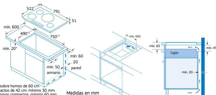
\* En instalación sobre hornos de 60 cm u hornos compactos de 42 cm: mínimo 30 mm. Con resto de hornos compactos: mínimo 60 mm.
