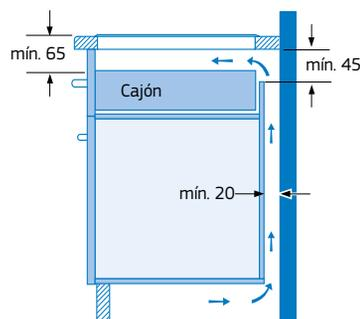
Con esta instalación se garantiza una correcta ventilación, pudiendo colocar un cajón funcional bajo la placa de inducción, sin necesidad de colocar rejillas, ni dejar huecos en la parte delantera.
